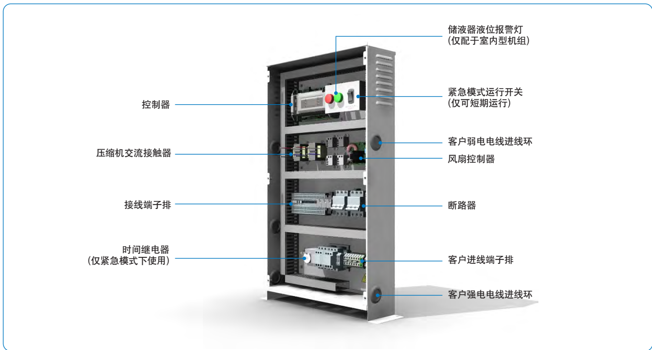
图11. 20HP机组的电气模块
