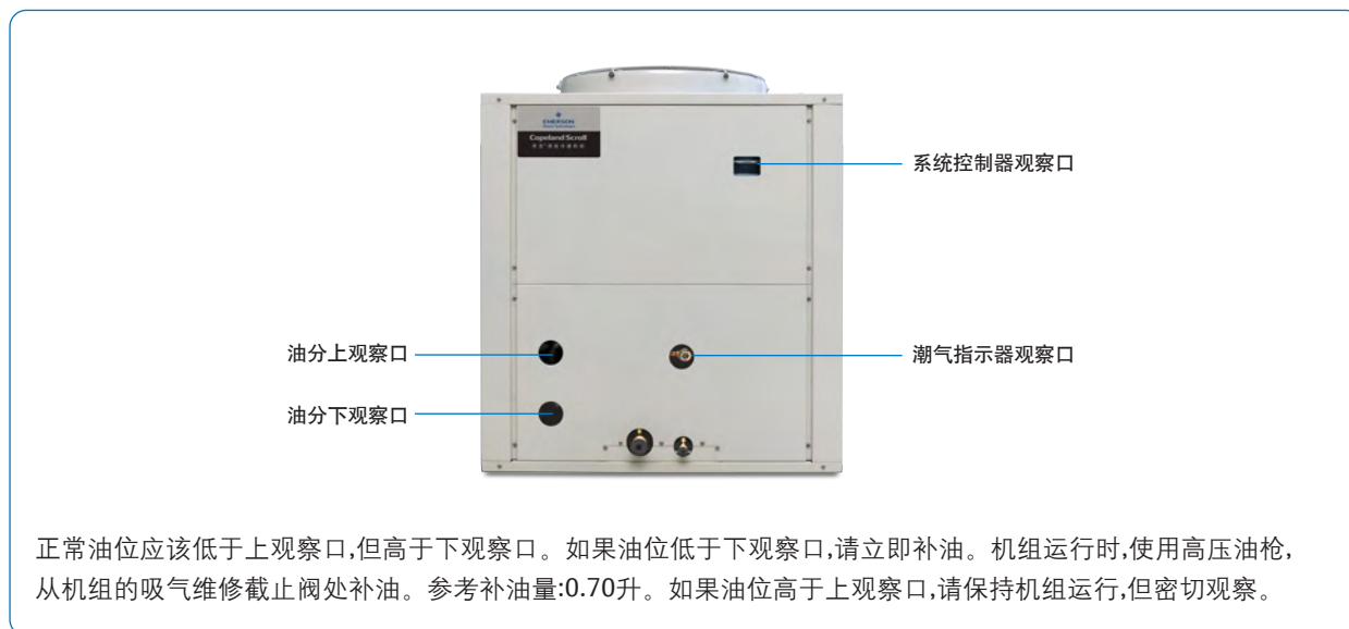
图1. 16HP室外型机组外形
