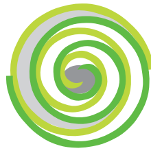
气体进入涡旋盘后, 开口封闭
